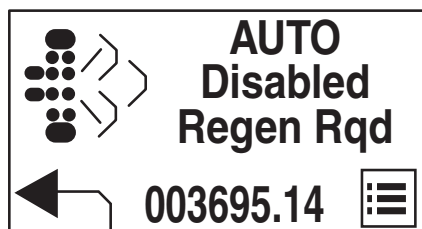
TCT012084—UN—26NOV14 Se requiere la limpieza automática, regeneración desactivada
