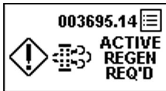
PY44599—UN—08SEP17 Pulizia automatica richiesta, Rigenerazione disabilitata
