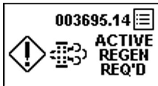
PY44599—UN—08SEP17 Se requiere la limpieza automática, regeneración desactivada
