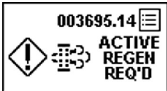
PY44599—UN—08SEP17 Automatické čištění vyžadováno, regenerace deaktivována
