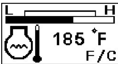
Ekran temperatury płynu chłodzącego silnika
