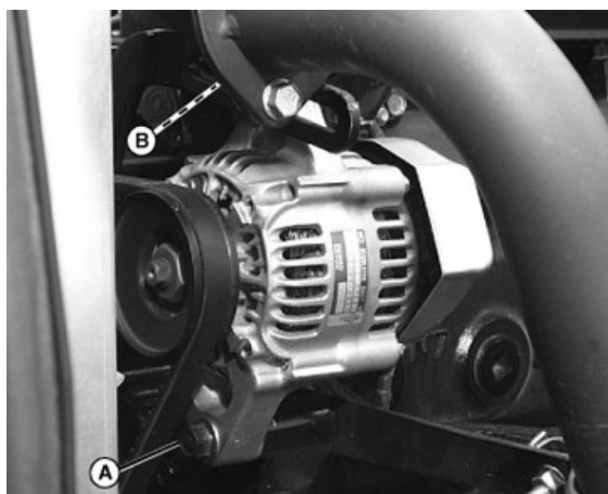
Alternator umieszczony z prawej strony silnika.
