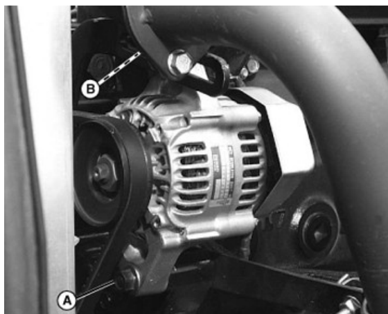
Generator på motorns högra sida.
