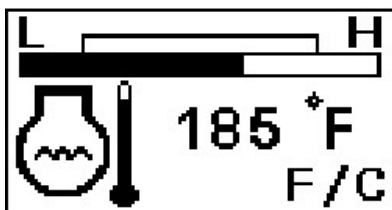
Skärm för motorns kylmedelstemperatur
