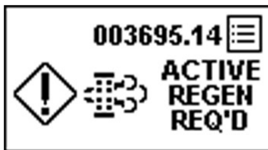
PY44599—UN—08SEP17 Limpeza automática necessária, Regeneração desativada
