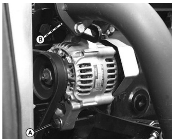
Dynamo på høyre side av motoren.
