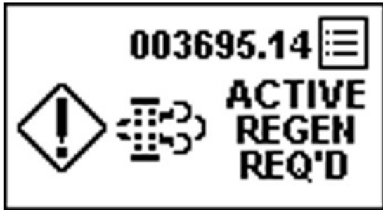
PY44599—UN—08SEP17 Automatisk rengjøring er nødvendig – regenerering deaktivert
