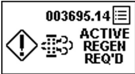
PY44599—UN—08SEP17 Otomatik Temizleme Gerekli, Rejenerasyon Devre Dışı
