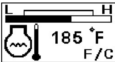
Obrazovka pre teplotu chladiacej zmesi motora
