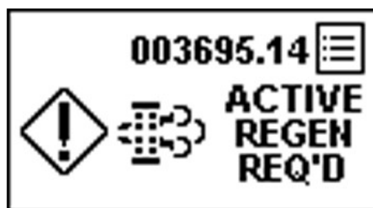
PY44599—UN—08SEP17 Limpeza automática necessária, Regeneração desativada
