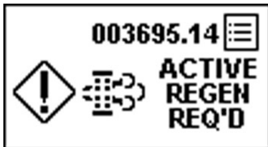
PY44599—UN—08SEP17 Automatické čištění vyžadováno, regenerace deaktivována
