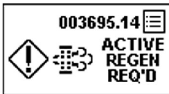
PY44599—UN—08SEP17 Wymagane automatyczne czyszczenie, regeneracja wyłączona
