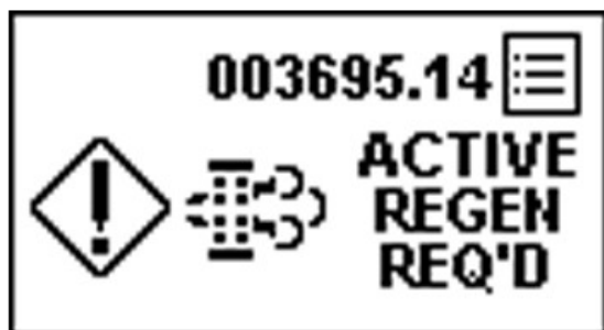
PY44599—UN—08SEP17 Parkeret regenerering påkrævet, regenerering deaktiveret
