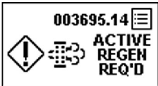
PY44599—UN—08SEP17 Automaattipuhdistusta tarvitaan, regeneraatio pois käytöstä
