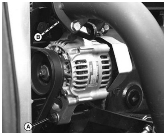
Generator på motorns högra sida.
