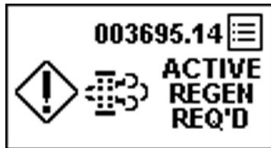
PY44599—UN—08SEP17 Limpeza automática necessária, Regeneração desativada
