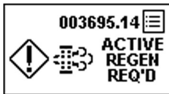
PY44599—UN—08SEP17 Parkeret regenerering påkrævet, regenerering deaktiveret
