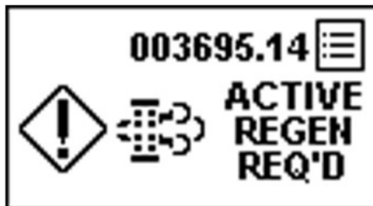
PY44599—UN—08SEP17 Automatische reiniging vereist, regeneratie uitgeschakeld
