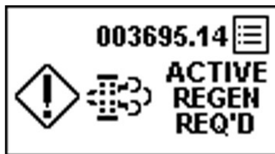
PY44599—UN—08SEP17 Limpeza automática necessária, Regeneração desativada
