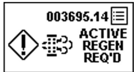
PY44599—UN—08SEP17 Auto-Reinigung erforderlich, Regeneration deaktiviert
