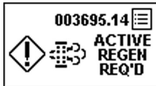
PY44599—UN—08SEP17 Limpeza automática necessária, Regeneração desativada
