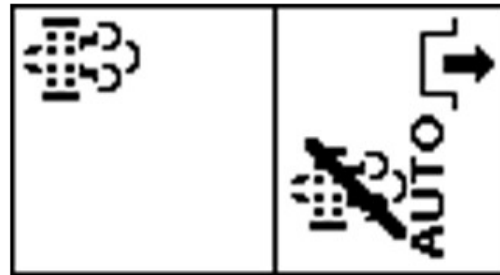
PY44610—UN—12SEP17 Vyžaduje sa čistenie - automatická regenerácia deaktivovaná
