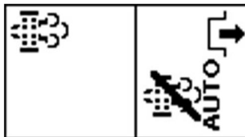
PY44610—UN—12SEP17 Vyžadováno čištění – automatická regenerace deaktivována
