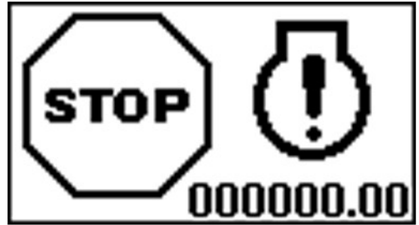
Generel motorfejl - status for stoplampe
