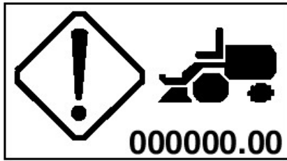
TC101636—UN—29OCT20 一般的な機械の故障：警告ランプステータス
