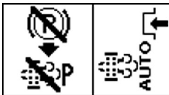
Hamulec postojowy jest zwolniony, blokada regeneracji na postoju
