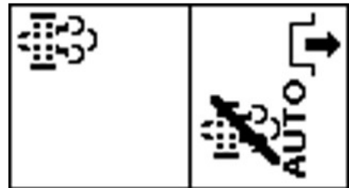
PY44610—UN—12SEP17 Reinigung erforderlich - Auto-Regeneration deaktiviert
