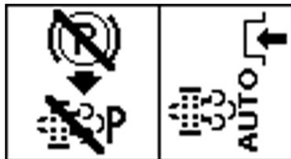
PY44594—UN—06SEP17 Feststellbremse deaktiviert, Regenerationssperre bei geparkter Maschine
