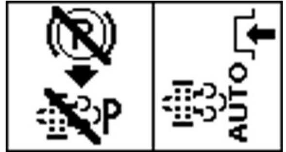
PY44594—UN—06SEP17 Stovėjimo stabdys išjungtas, regeneracijos stovint blokuotė
