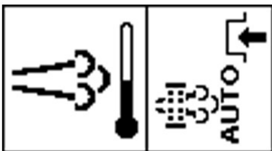
PY44600—UN—08SEP17 Podwyższona temperatura gazów spalinowych
