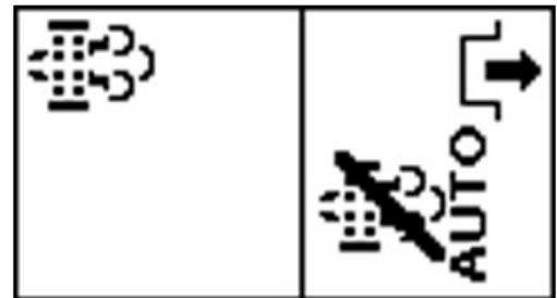
PY44610—UN—12SEP17 Nettoyage requis – Régénération automatique désactivée
