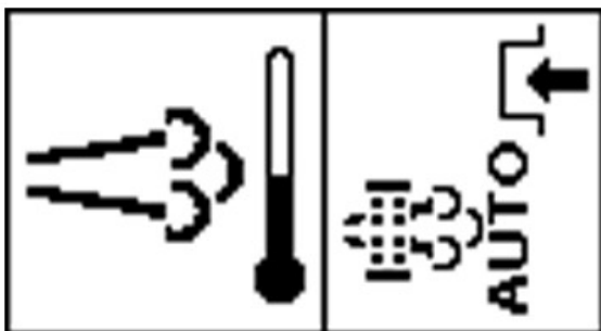
PY44600—UN—08SEP17 Temperatura gas di scarico elevata
