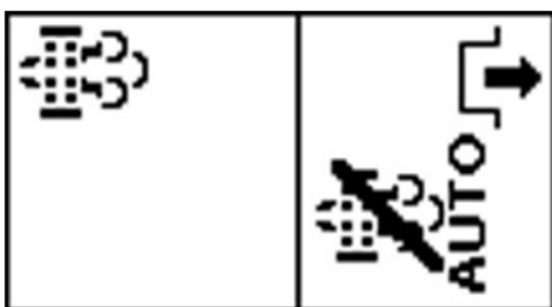
PY44610—UN—12SEP17 Ir nepieciešama tīrīšana — automātiskā reģenerācija ir atspējota
