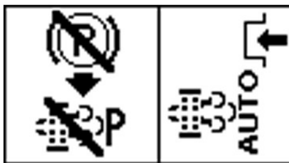
PY44594—UN—06SEP17 Freio de estacionamento desligado, o intertravamento da regeneração estacionária
