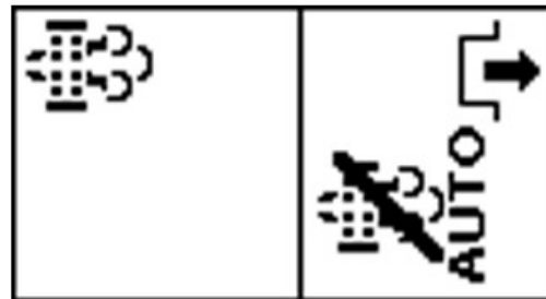
PY44610—UN—12SEP17 Reinigung erforderlich - Auto-Regeneration deaktiviert
