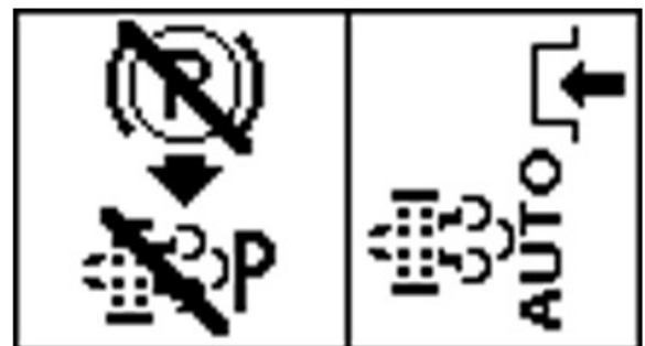
PY44594—UN—06SEP17 Feststellbremse deaktiviert, Regenerationssperre bei geparkter Maschine
