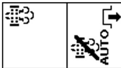
PY44610—UN—12SEP17 Pulizia necessaria - Rigenerazione automatica disabilitata
