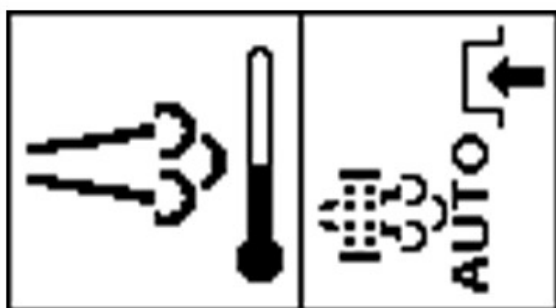
PY44600—UN—08SEP17 Temperatura gas di scarico elevata
