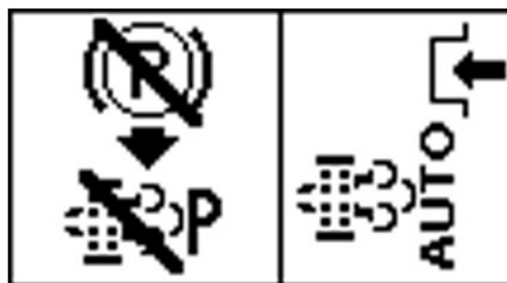
PY44594—UN—06SEP17 Freno di stazionamento disinserito, l'interblocco della rigenerazione in posizione di Parcheggio
