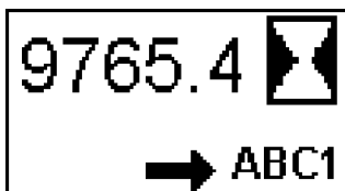
Pantalla de nivel superior del cuentahoras de funcionamiento del tractor
