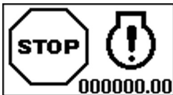
PY44596—UN—06SEP17 Anomalie générique du moteur – État du témoin d'arrêt
