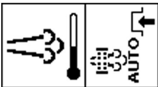
PY44600—UN—08SEP17 Température élevée des gaz d'échappement
