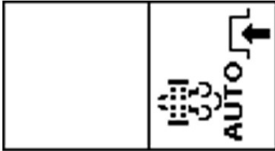
PY44595—UN—06SEP17 Auto Regeneration Enabled
