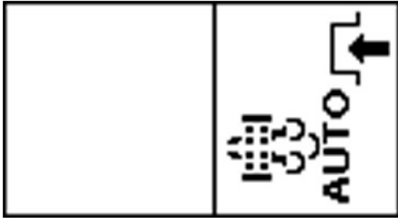
PY44595—UN—06SEP17 Auto Regeneration Enabled
