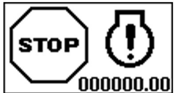
PY44596—UN—06SEP17 Allgemeine Motorstörung – Stoppleuchtenstatus
