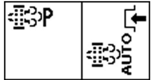
Park Halinde Temizleme Gerekli (Amber Rengi Uyarı Lambası)
