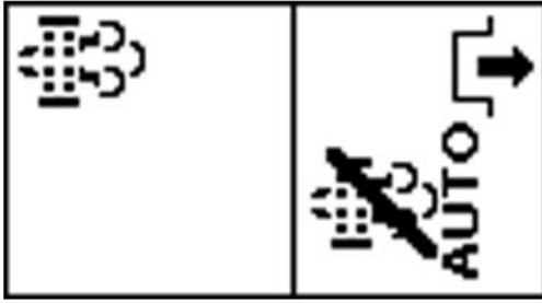
Temizleme Gerekli - Otomatik Rejenerasyon Devre Dışı
