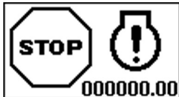
Všeobecná porucha motora – stav brzdového svetla
