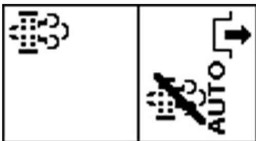
PY44610—UN—12SEP17 Vyžaduje sa čistenie - automatická regenerácia deaktivovaná
