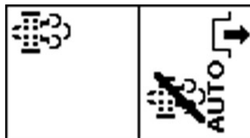
PY44610—UN—12SEP17 Nettoyage requis – Régénération automatique désactivée
