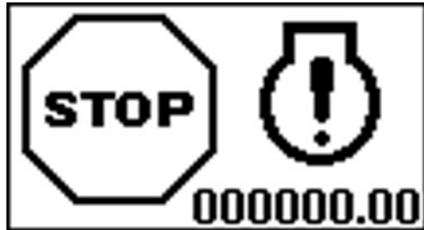
PY44596—UN—06SEP17 Allgemeine Motorstörung – Stoppleuchtenstatus
