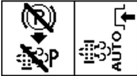
PY44594—UN—06SEP17 Feststellbremse deaktiviert, Regenerationssperre bei geparkter Maschine
