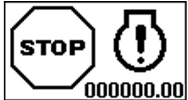
PY44596—UN—06SEP17 Anomalie générique du moteur – État du témoin d'arrêt
