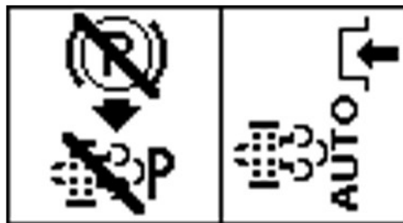
PY44594—UN—06SEP17 Freio de estacionamento desligado, o intertravamento da regeneração estacionária
