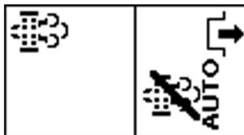
PY44610—UN—12SEP17 Pulizia necessaria - Rigenerazione automatica disabilitata
