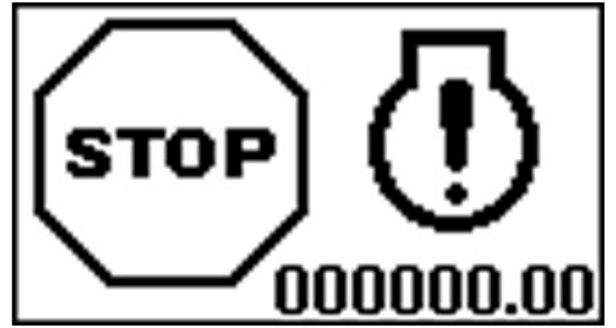
Genel Motor Arızası – Durdurma Lambasının Durumu
